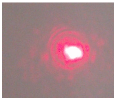
Figura 14 - Fenômeno de difração circular
