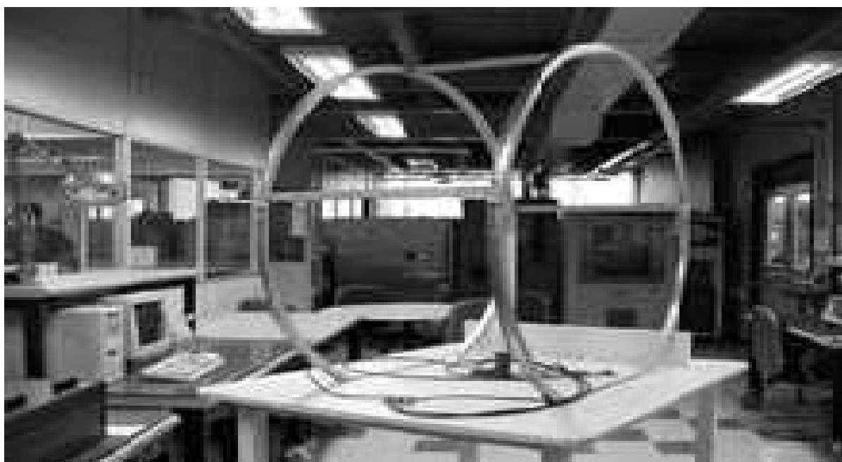
Fig 22: Bobina de Helmholtz. In: Robert, R. “ Bobina de Helmholtz ”, RBEF, v.25, Março, 2005. pp 43. Dados desta bobina: R = 0,528\text{m} e N = 230 espiras, corrente máxima admissível para trabalho contínuo é 2,5 A.
