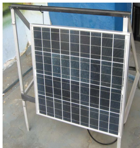
Figura 9 - A) Aerogerador de 350 W de potência e corrente máxima de 40A utilizado em veleiros. B) Célula solar ou módulo fotovoltaico da 50 W de potência.
