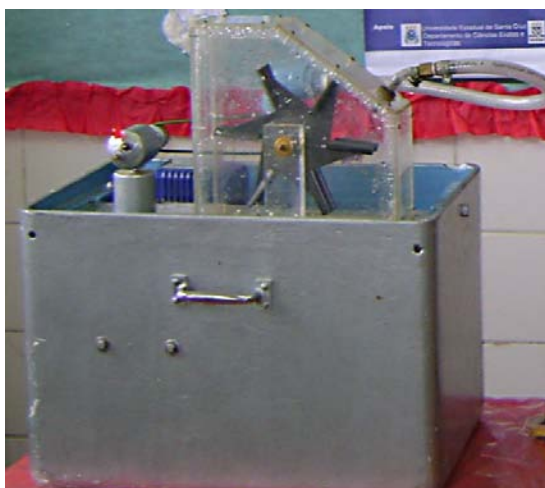
Figura 16: modelo de usina hidrelétrica.
