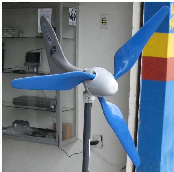
Figura 10 - Aerogerador de 350 W de potência e corrente máxima de 40A utilizado em veleiros
