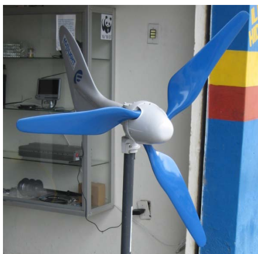
Figura 9 - A) Aerogerador de 350 W de potência e corrente máxima de 40A utilizado em veleiros. B) Célula solar ou módulo fotovoltaico da 50 W de potência.
