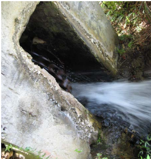
Figura 9 - A) Roda d'água da micro usina hidreletrica da fazenda Parafuso. B) Represa e canos de PVC no rio Caldeira para escoamento da água para a micro usina.
